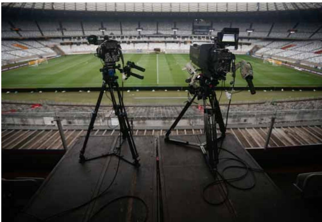
**Câmera de ângulo reverso (7):** Nível de inclinação em uma pequena plataforma elevada na frente da câmera principal, instalada em uma posição central localizada entre as linhas de 16m.
