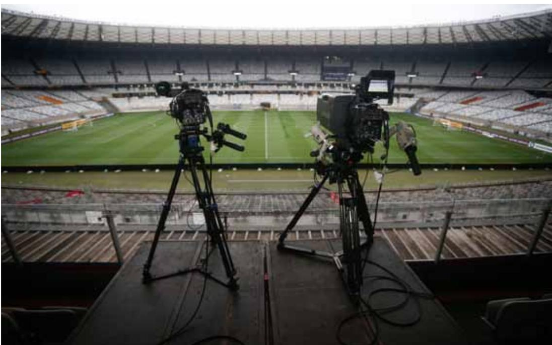
**Câmera 10- VAR Reversa:** Nível de inclinação em uma pequena plataforma elevada em frente à câmera principal, ao lado da câmera 7 - Reversa, instalada em uma posição central localizada entre as linhas de 16m. Esta câmera segue a ação do jogo em plano inverso e fechado o tempo todo; ela é usada pelo VAR.
