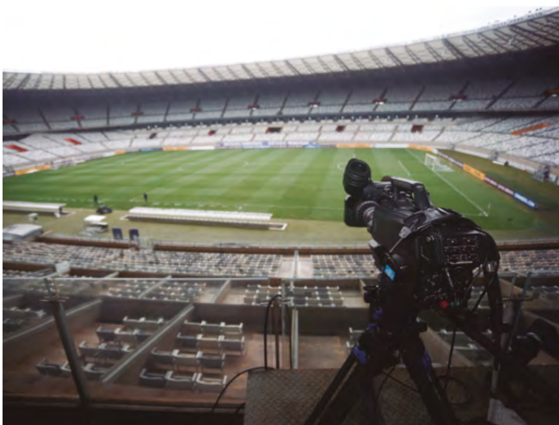
16m/ Off Side (5 e 6): Duas câmeras instaladas exatamente nas linhas de 16,5m, linhas de off side, no mesmo nível ou mais alto que a plataforma da câmera principal.
