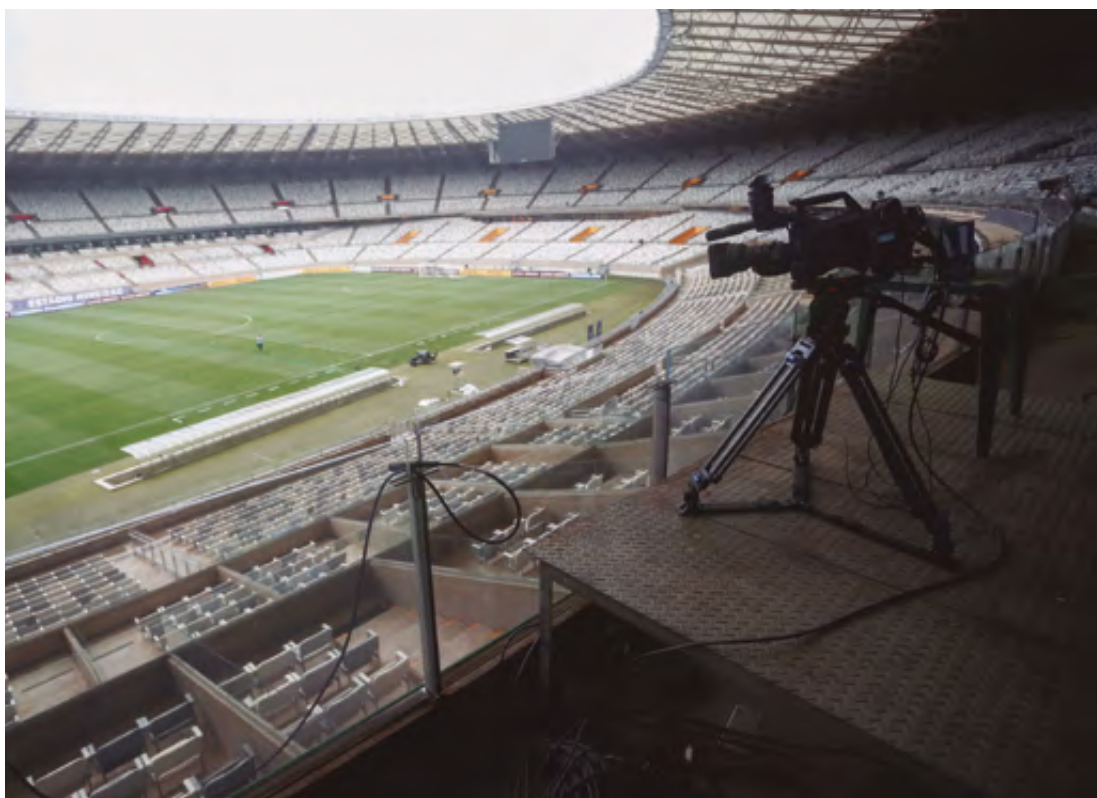
16m/ Off Side (5 e 6): Duas câmeras instaladas exatamente nas linhas de 16,5m, linhas de off side, no mesmo nível ou mais alto que a plataforma da câmera principal.
