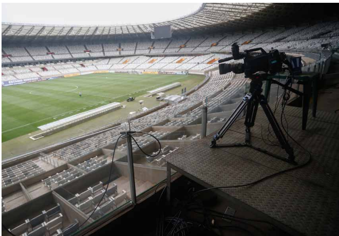
Cámaras fuera de Lugar (5 y 6): Dos cámaras instaladas exactamente en las líneas 18 y, al mismo nivel o más alto que la plataforma de la cámara principal.
