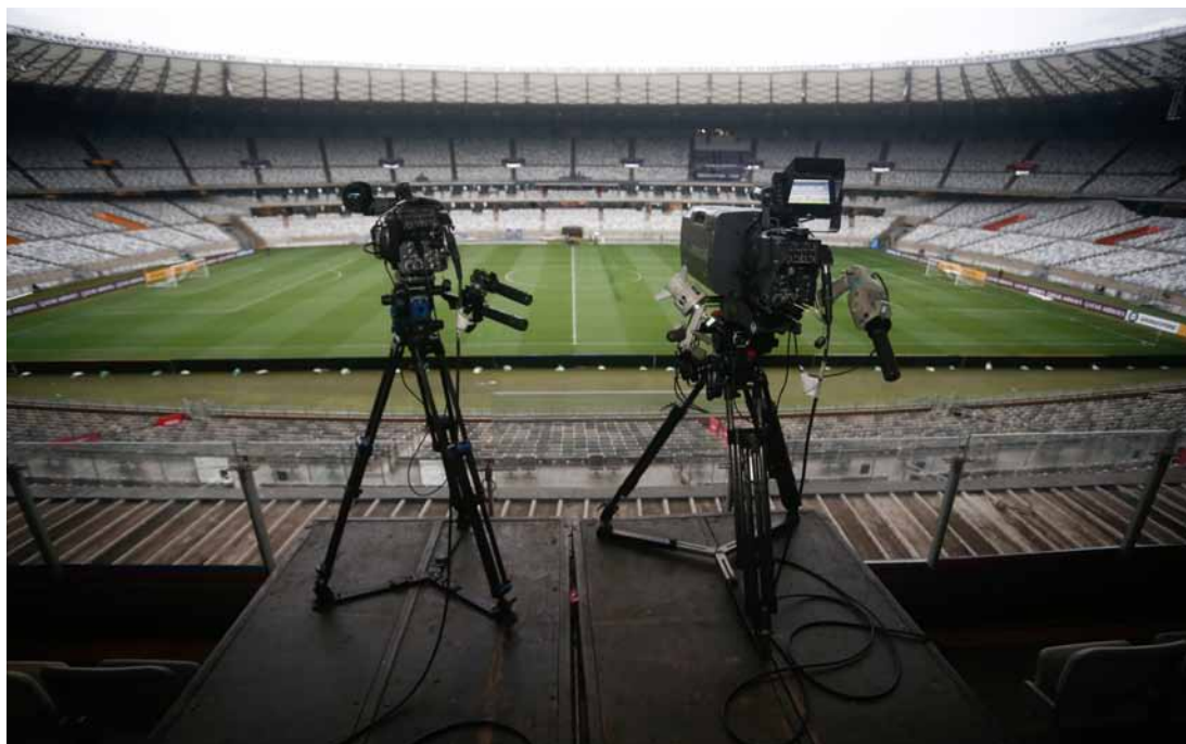
Cámara de ángulo reverso (7): Nivel de inclinación en una pequeña plataforma elevada frente a la cámara principal, instalada en una posición central ubicada entre las líneas de 16m.
