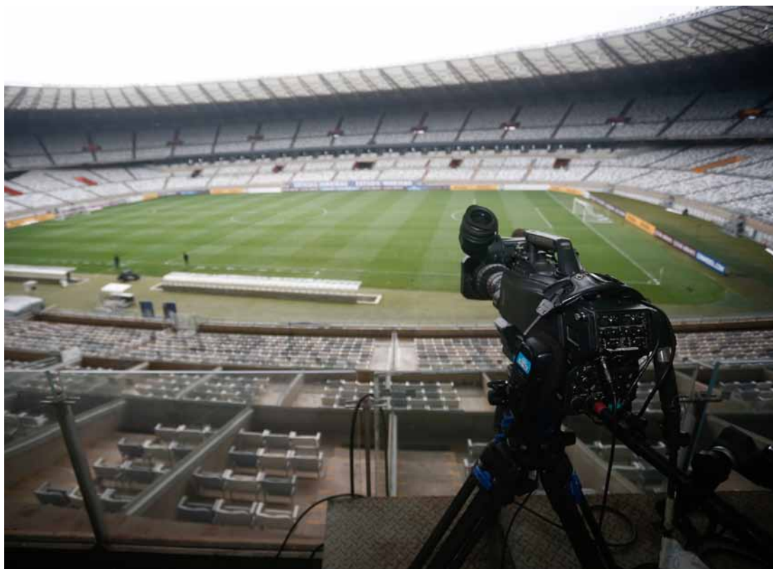
Câmeras da linha de impedimento (5 e 6): Duas câmeras instaladas exatamente nas linhas de 18 jardas, no mesmo nível ou mais alto que a plataforma da câmera principal.
