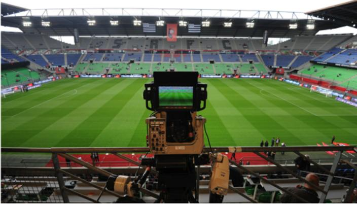
Esta cámara debe colocarse en el soporte principal, situada exactamente en la línea media, cubierta y alejada del sol. Se utiliza para proporcionar la cobertura principal del juego.
